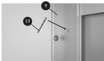
3.4 Через отверстия на боковых частях регулировочных профилей 9 с помощью сверла 19 просверлите отверстия в боковых профилях 8. Скрепите профили с помощью саморезов 4\*12 18.
